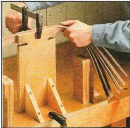
5. Сцентрируйте планку на стойке. Прижмите их так, чтобы верхние ребра были выровнены.
