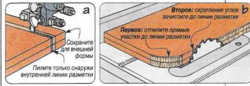
Выпиливать (лучше электролобзиком) формы начинают с внутренней стороны первой линии разметки (рис. 1,а). Скругления углов зашкуривают (рис. 1,б). По периметру внутренней формы сверлят отверстия для «пяток» струбцин (рис. 3). Затем на клею и шуру-
