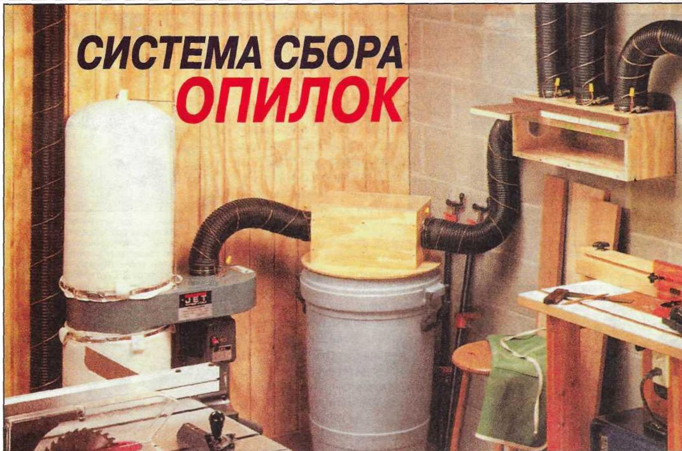
**При механической обработке древесины, особенно высокоскоростными инструментами, образуется большое количество древесной пыли и опилок, от которых работающему приходится защищать органы дыхания и зрения, облачаясь в респиратор и очки. А что если в мастерской создать централизованную систему очистки воздуха и сбора опилок? Ведь даже ручные электроинструменты оснащают мешочками для сбора опилок.**
