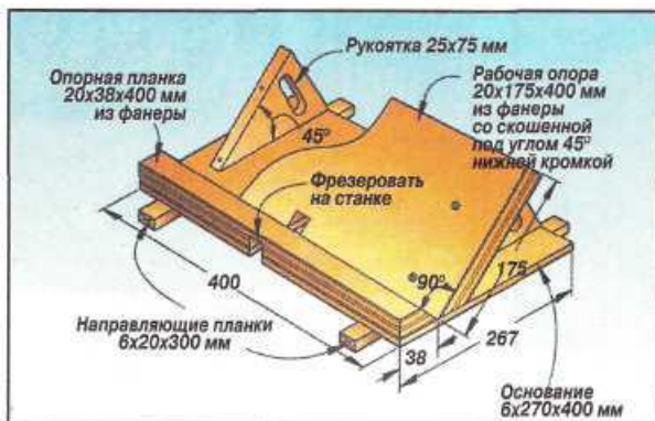
Приспособление для фрезерования пазов.
