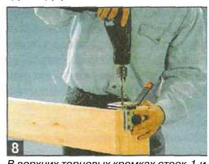
8 В верхних торцевых кромках стоек 1 и в нижних кромках стоек 2 сверлят по два отверстия для шкантов Ø8 мм.
