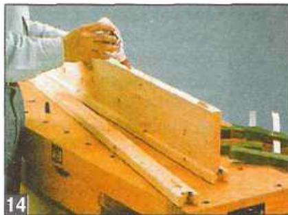
14 Ограждение 8 крепят с помощью накладок 10, в торцах которых, как и в поперечинах лестницы, делают вырезы для соединения с вертикальными стойками спинок.
