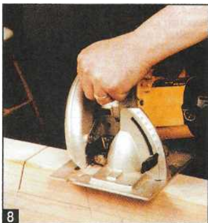
8 И снова циркулярная пила. Сначала выпиливают заплечики, затем в удаляемом материале делают пропилы.
