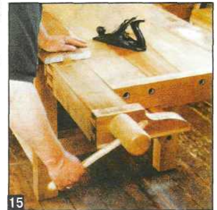
15 Для определения положения отверстия винта тисков вводят собранные тиски на место. Таким способом определяют, где винт будет проходить через торец задних тисков и на сколько сами тиски будут выступать за габариты верстака.
