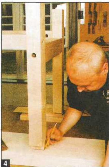
4 Определение положения гнезд для стоек на брус из клена. Прежде всего, кладут брус лицевой стороной вниз и выравнивают задние стойки.
