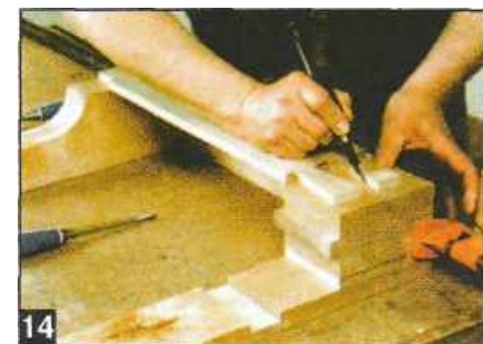
14 Копрус тисков имеет коробчатую конструкцию: боковина, нижняя и верхняя доски и щеки соединены на клею «ласточкиным хвостом». Для точности соединений разметку ведут по месту.
