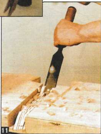
11 Задние тиски — трехсторонняя коробка с закрытыми торцами. Губка — прямоугольник шириной 100 мм из твердой
