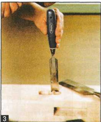
3 Затем стамеской доводят их форму до прямоугольной. При подгонке соединений подрезают шипы.
