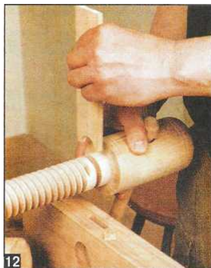
12 Вкладыш обеспечивает перемещение щеки тисков. Эта тонкая полоска вставляется в щеку и заходит в паз на шейке винта.
