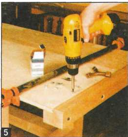
5 Фанеру усиливают торцевыми планками. Каждую торцевую планку крепят болтами к брусу из клена и промежуточной рейке, установленной заподлицо с бруском. К промежуточной планке и четверти, выбранной на заднем ребре бруса, фанеру крепят шурупами.
