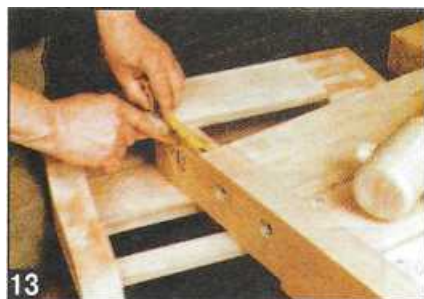
13 Задние тиски - ящик с одной открытой стороной. Торцы тисков (на переднем плане) собирают из тонких заготовок. Противоположный торец сделан в виде «утиного носа». Верхняя, нижняя и боковые детали крепятся торцами большими соединениями типа «ласточкин хвост».
