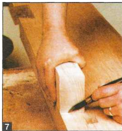
7 После подрезки боковых сторон резьбовых блоков под углом размечают пазы для них. Трапециевидная форма плюс клей повышают механическую прочность крепления.
