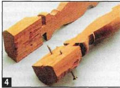
**4** Заготовку для полуколонн собирают из двух половинок, скрепляя их по краям шурупами. Крепление должно быть очень прочным и надежным.
