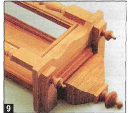
**9** Большую фиалу придется срезать примерно на одну треть по диаметру, чтобы она не выступала за пределы задней кромки корпуса и плотно прилегала к стене.
