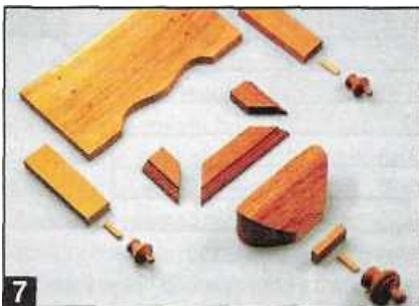
**7** Фиалы и профилированные окантовочные планки делают из ореха, остальные детали - из сосны, оклеенной шпоном.
