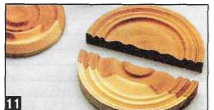
**11** Заготовки розетки фронтона и его навешива закрепляют на оправке, просверлив в центре с тыльной стороны глухое отверстие и подрезывая шпильку. После обтачивания обе детали распиливают на две равные части.
