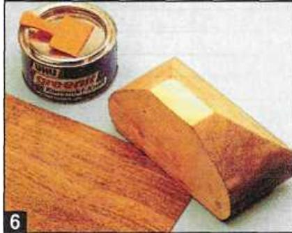
**6** Фигурную подставку выпиливают с помощью лобзика. Окончательную форму придают рашпилем, напильниками и наждачной бумагой. В заключение внешние поверхности оклеивают ореховым шпоном.
