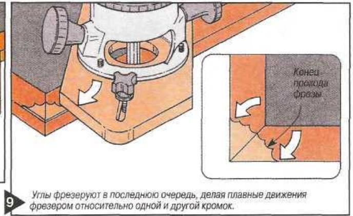
щий упор с фрезерной машинкой вдоль кромки. Так повторяют проход за проходом, пока не будут отфрезерованы окантовочные рейки по всей длине, за исключением углов (рис. 8). Во избежание сколов при обработке углов следует соблюдать опре-
