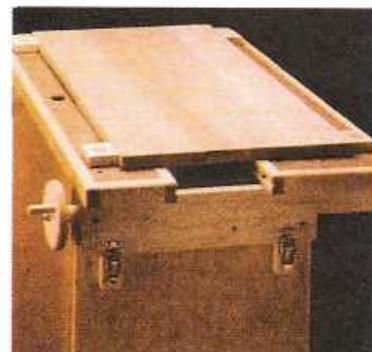
Установив упоры, на верстаке можно зажимать детали шириной до 425 мм.
