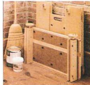
Для хранения верстака достаточно освободить стяжки-фиксаторы, снять крышку и сложить ножки.
