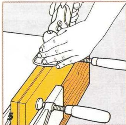
**Кромки стыков в собираемых в лист полосах шпона выравнивают рубанком, закрепляя полосы между двумя прокладками.**
