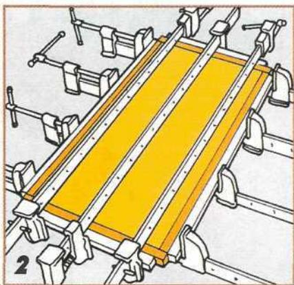
**Для временного (пока не подсохнет клей) скрепления накладок с плитой-основой используют различные по своему устройству приспособления. Одно из них (его обычно используют профессиональные столяры) показано на рисунке. Умельцы же применяют, как правило, обычные и угловые струбцины или стягивающие ремни.**
