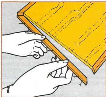
**Запиленные на ус накладки крепят к кромкам ДСП на клею и штифтах с последующим заглублением их головок.**
