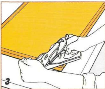
**Прежде чем наклеивать шпон, подстругивают и шлифуют кромочные накладки заподлицо сплатью плиты-основы.**
