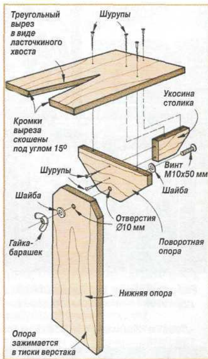
Рис. 1. Столик-подставка «ласточкинхвост» для выпиливания лобзиком.
