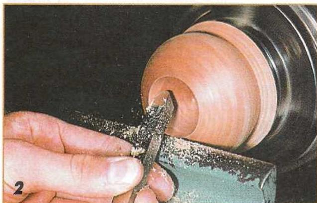
**Точение крышки.** Сначала обтачиваю внешнюю поверхность крышки, затем вытачиваю полость. Чтобы крышку можно было надеть на корпус, полость выпиливаю с ободка высотой 5 мм.
