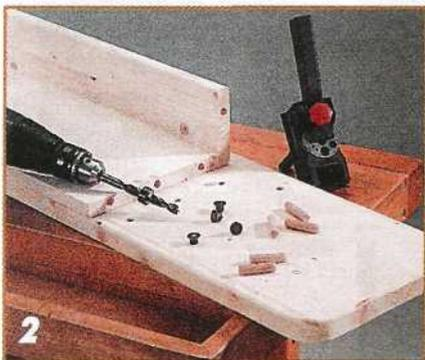
Чтобы точно соединить деревянные детали, используют кондуктор, сверло с ограничителем глубины сверления, а также маркеры для разметки отверстий под шканты.
