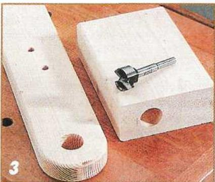
Отверстия, в том числе глухие, под деревянные стержни, на которых поворачивают парту и подлокотник, выбирают дрелью со сверлом Форстнера Ø30 мм, закрепленной в вертикальном штативе.
