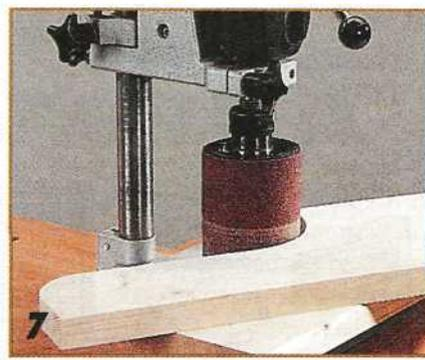
Шкурка, заправленная в специальную оправку для дрели, позволяет эффективно обработать кромки и скруглить углы.
