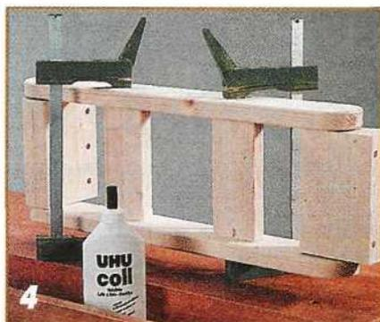
Поручень собирают и фиксируют струбцинами, соединив центральные опоры с продольными поперечинами на шкантах с клеем. Предварительно надвставляют в боковые опоры поворотные стержни.
