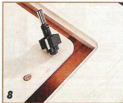
В раме фрезерной машинкой выбирают паз для установки фанерной поверхности грифельной доски.
