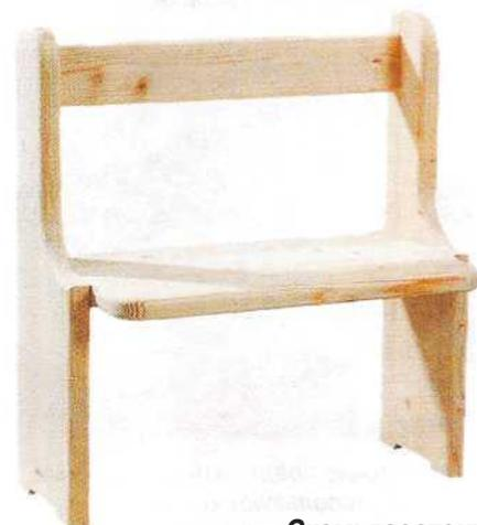
Скамья состоит из четырех частей, соединенных на шкантах с клеем. Все углы и кромки, чтобы уберечь детей от травм, должны быть скруглены.
