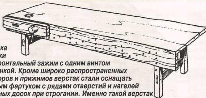
**Рис. 5. Современный верстак краснодеревщика.** Хотя многие столяры и сегодня делают верстаки сами, наиболее распространены стандартные верстаки промышленного изготовления с массивной крышкой, рядом гнезд под переставляемые упоры и прижимы. Ходовые винты зажимов на этих верстаках всегда делают стальными, а прижимные губки — из твердой древесины.
