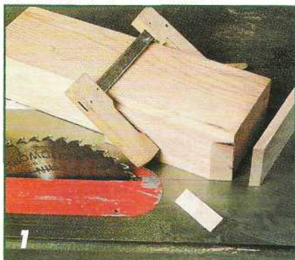
1 Чтобы опилить деталь крышки под нужным углом, ее необходимо прижать к блоку, который перемещается по направляющему пазу стола пилы.
