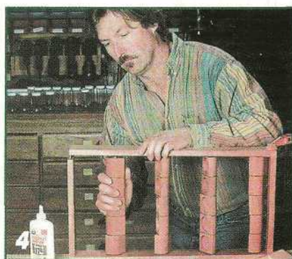
4 Вторую боковую стенку по очереди надевают на оси, переходя от одной стенки корпуса к другой.
