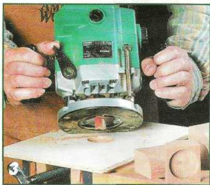
3 Гнезда для крышек можно быстро и точно отфрезеровать с помощью самодельного шаблона, зажатого в тисках верстака.
