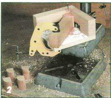
2 Специальное приспособление гарантирует точное положение отверстий. Удлинитель прижимает обрабатываемую деталь к линейке приспособления.
