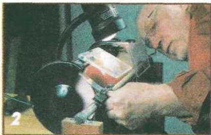
**Проверка углов заточки. Стамеску вставляют в держатель и прикладывают ее к заточному кругу. Изменяя установку стамески в держателе, регулируют углы заточки.**
