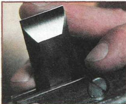
**Безупречная кромка.** Чистую, прямую под углом 90° к оси режущего инструмента фаску можно быстро заточить и заправить.
