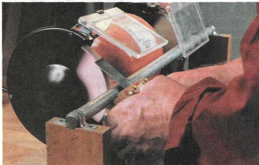
На первом этапе заточки инструмента обычно формируют на заточном круге фаску с профильным желобом (рис. 1). На втором — на оселке затачивают и заправляют режущую кромку.
