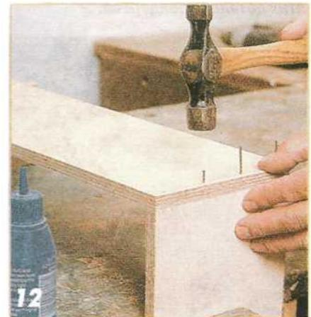
Остов выдвижного ящика соберите на клею и оцинкованных гвоздях из фанеры толщиной 12 мм.
