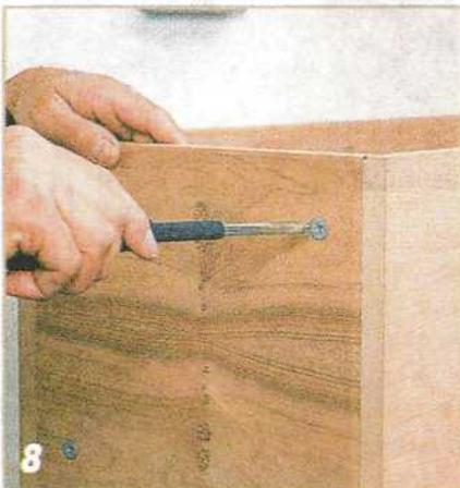
Кулачковые шайбы мебельного крепежа поверните крестообразной отверткой или отверткой с плоским жалом.
