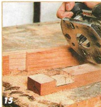
**15** Большую часть древесины из пазов выберите стамеской, а фрезером обработайте пазы до нужной глубины.
