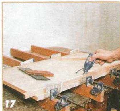
**17** Приклейте с помощью струбцин к ребрам крышки стола брусочки сечением 20x20 мм.
