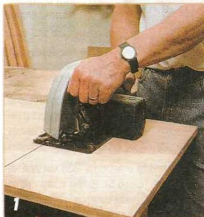
1 Разметьте и распилите 18-мм столярную доску на заготовки для крышки стола и деталей тумбочки.
