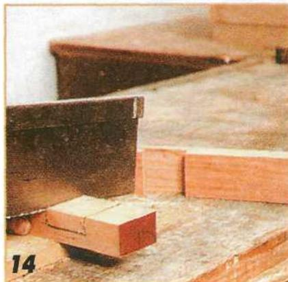
**14** В деталях рамы правой неподвижной опоры стола разметьте и выберите пазы для соединения этих деталей вполдерева.
