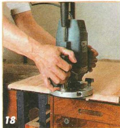
**18** Когда клей высохнет, зачистите окантовку ступенчатой фрезой с пластинами и скруглите ее верхние ребра соответствующей фрезой.
