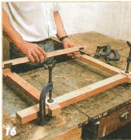
**16** Склейте и затяните раму боковины шурупами. Чтобы губки струбцины не повредили древесину боковины, под них подложите деревянные прокладки.
