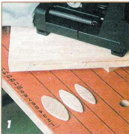
**Размер шпонок выбирают с учетом толщины деталей и необходимой прочности соединения. Для деталей из ДСП ширину плоской овальной шпонки обычно берут равной толщине плиты.**
