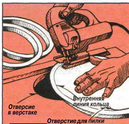
Рис. 6. Вырезать внутреннюю часть заготовки кольца будет намного проще, если в столешнице верстака сделать небольшое отверстие.
