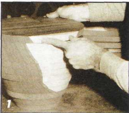
Выпилив все заготовки по внешнему контуру и сложив их вместе, можно оценить, как будет выглядеть готовое изделие.
